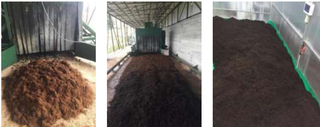
Şekil 1. Çay atıklarının kompostlanmasında kullanılan windrow kompostlayıcı ve kompost eldesi
