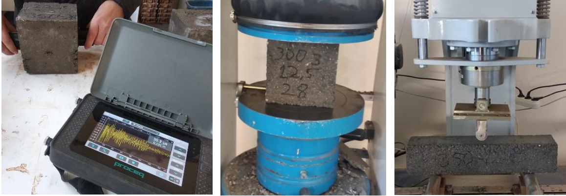
Şekil 4. Ultrases geçiş hızı, basınç ve eğilme dayanımı deney görüntüleri
