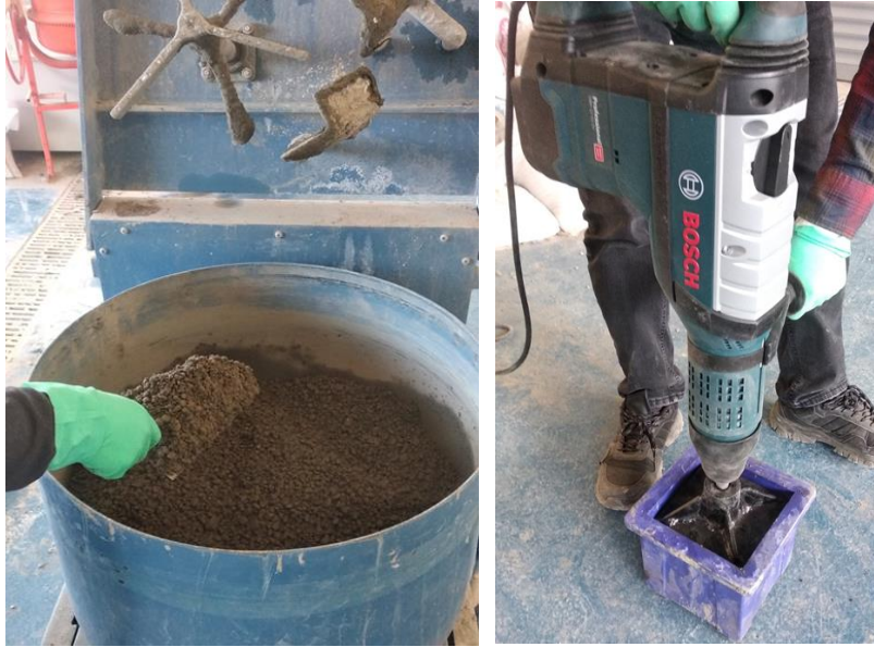
Şekil 2. SSB'nin mikserde üretimi ve titreşimli çekiç ile sıkıştırılması
