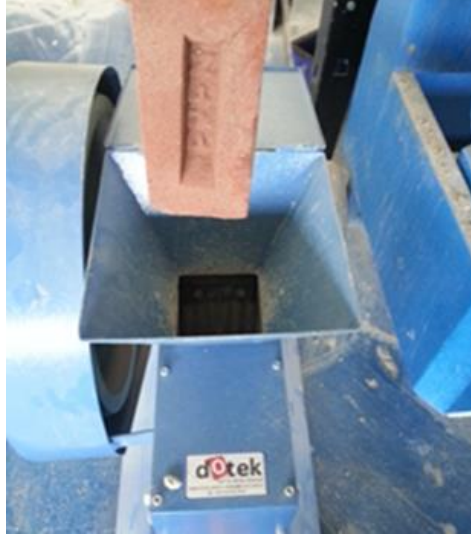
Şekil 1. Tuğlanın çeneli kırıcıda 0-4mm boyuta getirilme aşaması
