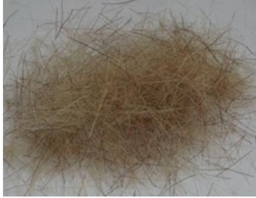
Şekil 2. 19mm uzunluğunda kesilmiş, lif olarak kullanılan keçi kılları
