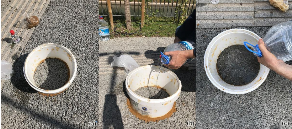
Şekil 5. Peynircioğlu Deresi kıyısı geçirimli beton infiltrasyon testi aşamalarından fotoğraflar (a) infiltrasyon halkası kurulumu aşaması, (b) Ön ıslatma aşaması, (c) İnfiltrasyon hızı ölçüm aşaması (Orijinal, 2021)
