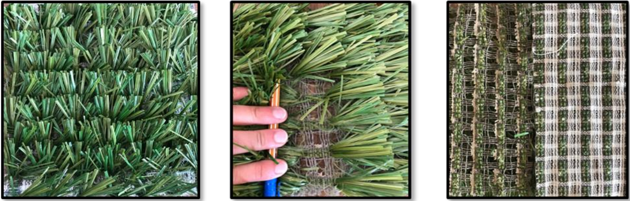
Şekil 2. Halı tabanlı sistem örneği (XtraGrass hibrit çim)
