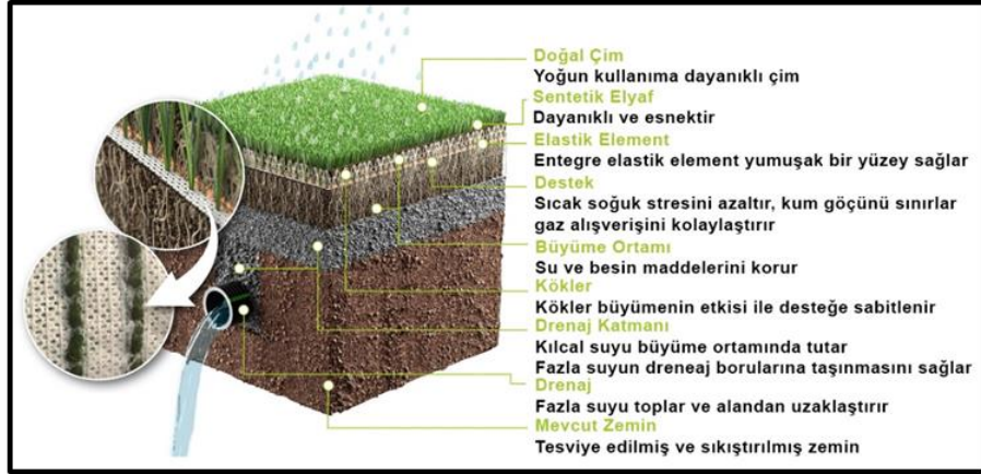
Şekil 3. Halı tabanlı sistem kesit görünümü (URL-9)
