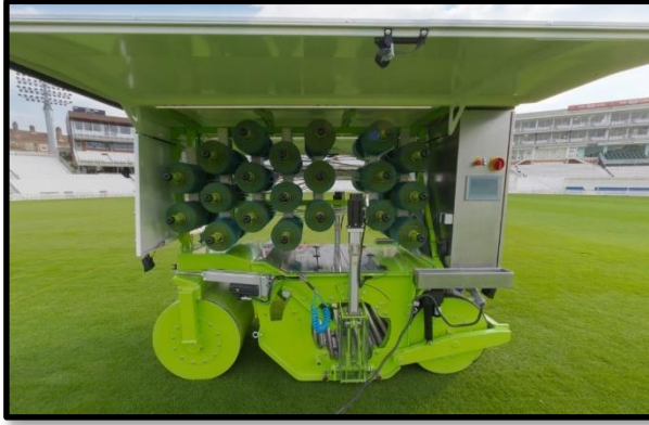
Şekil 7. Kalıcı sistem yönteminin futbol sahasına uygulanması (XtraGrass) (URL-13)
