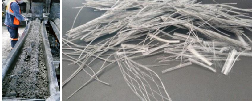
Şekil 1. PP donatılı travers üretimi ve kullanılan PP ürünlerin yakından görünüşü
