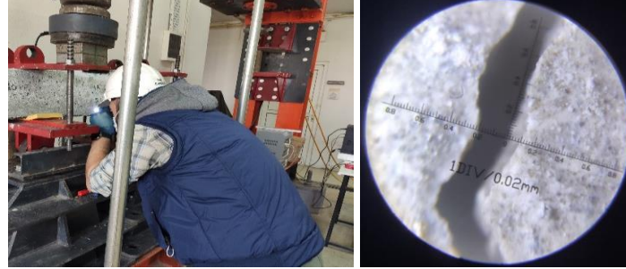
Şekil 2. Testler esnasında çatlak başlangıç yükü belirlenmesi ve çatlak genişlik ölçümü işlemleri
