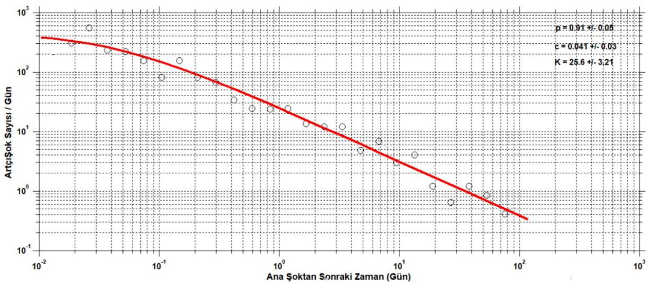
Şekil 6: 02 Mart 2007 Samsat Depremi (Ml=5.7) artçı şok azalım oranı. p, c ve K değerleri şekil üzerinde verilmiştir
