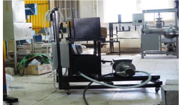
Şekil 1. Karıştırma ve ön pompalama tankı.
