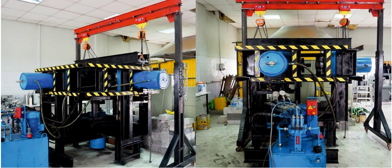
Şekil 14. İmal edilmiş hücre ve ona bağlı vinç.
