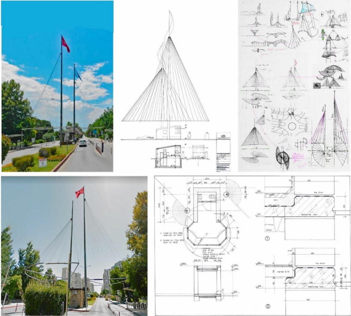
Şekil 3. Akdeniz Üniversitesi'nin yıkılan giriş kapısı fotoğrafları ve çizimleri (Salt Araştırma, Cengiz Bektaş Arşivi ve Google Street view)
