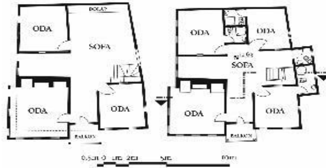
Şekil 44.Solda orijinal sağda restorasyon birinci kat planı (Nevnihal Erdoğan, 2018)
