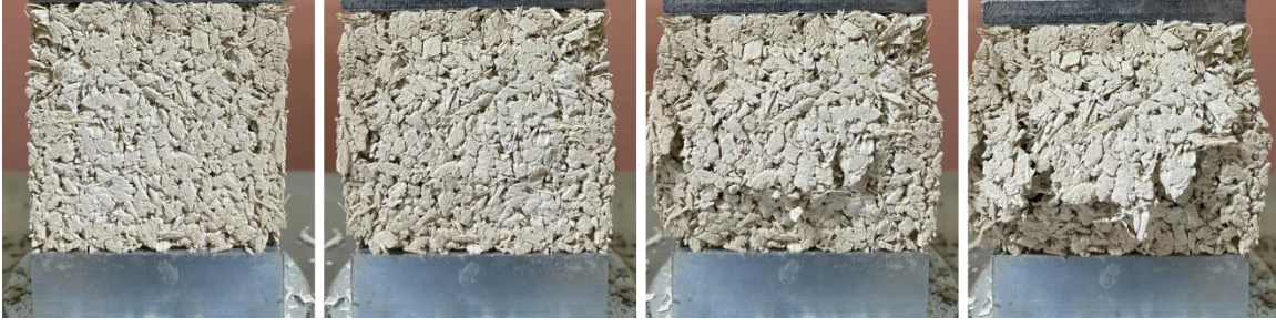
Şekil 2. Basınç dayanım testinin 100HK numunesi üzerinde gerçekleştirilmesi.
