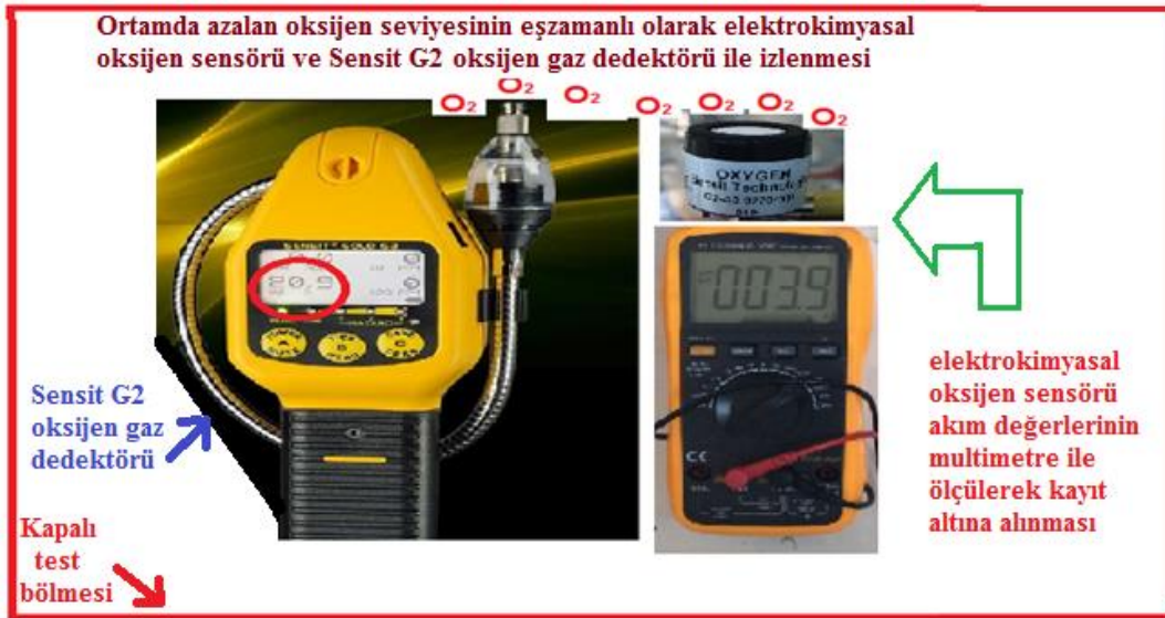
Şekil 5. Kapalı bölme içerisinde oksijen seviyesi düşürülerek Sensit G2 gaz dedektörü ve oksijen sensörü aynı anda çalıştırılarak düşen oksijen yüzdelere karşılık gelen akım değerleri oksijen gaz seviyesi ölçümünde kullanmak için kayıt altına alınmıştır.
