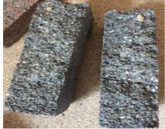
Şekil 10. Yarmada çekme deneyi sonucu kırılmış numune
