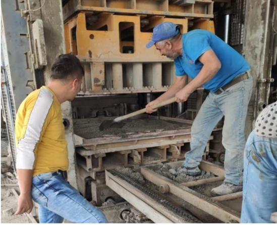
Şekil 3. Beton parke makinasına betonun yerleştirilmesi
