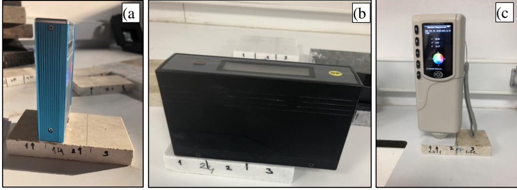
Şekil 5. Çalışmada kullanılan cihazlar (a) pürüzlülük, (b) parlaklık (c) renk ölçüm cihazlarının görünümü.
