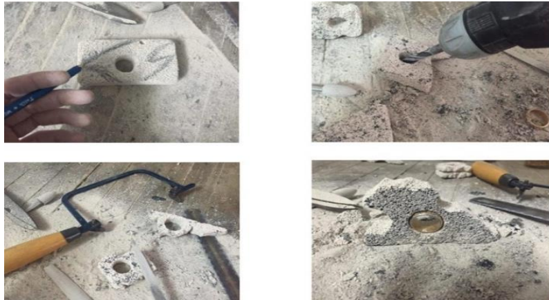
Şekil 22. Ponza taşının tasarıma uygun şekilde biçimlendirilmesi aşaması Figure 22. The stage of shaping the pumice stone in accordance with the design
