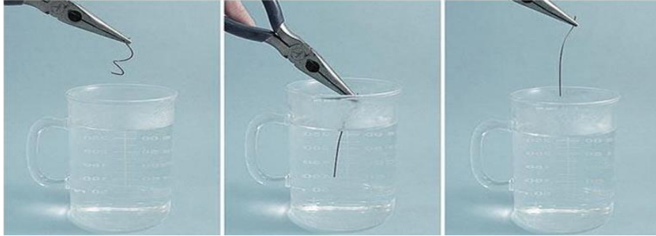
Şekil 21. Şekil hafızalı telin önceki formuna geri dönme aşamasının test edilmesi Figure 21. Testing the revert phase of the shape memory wire to its previous form
