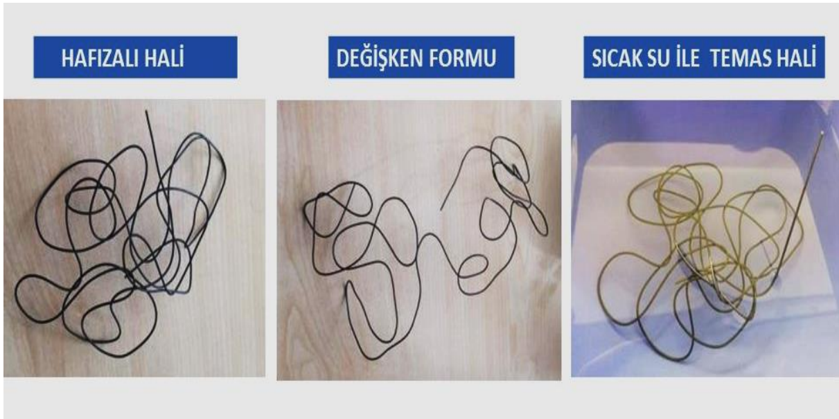
Şekil 17. Nitinol tel ile yapılan deneysel çalışmalar
