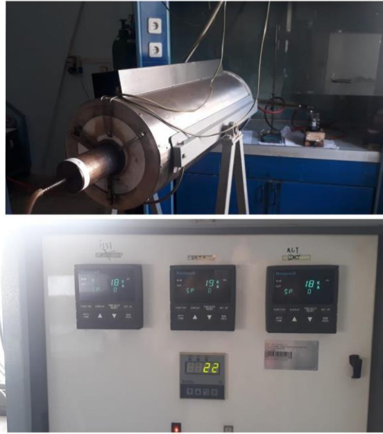
Şekil 1. Karbonizasyon işleminin yapıldığı üç zonlu borusal fırın
