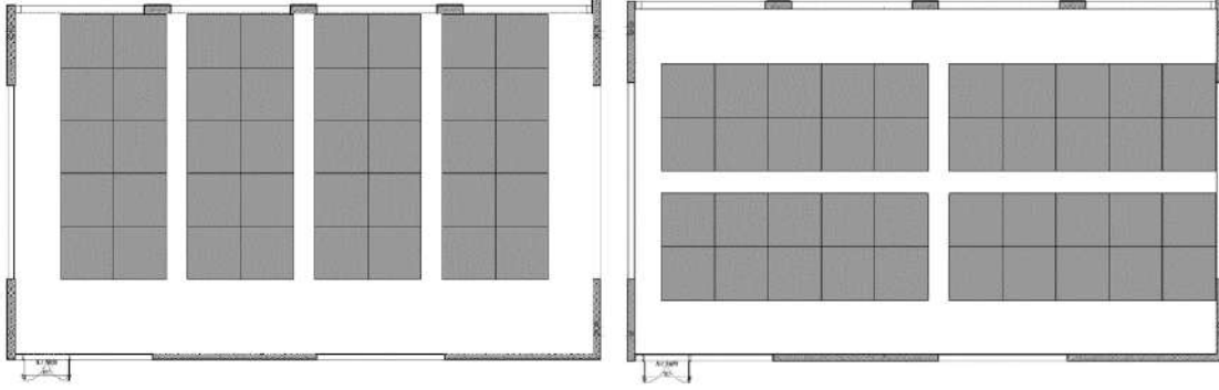
Şekil 10. 11 kişilik grupların maksimum kapasite ile stüdyoya yerleştirilmesi (gri-4m 2 / sarı-4m 2 'den az / beyaz-sirkülasyon)
