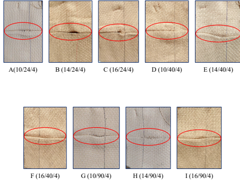
Şekil 16. 2 numaralı kumaşta atkı yönünde 4 sıklık ile dikim yapılmış numunelerin test esnasındaki yırtılma noktaları
