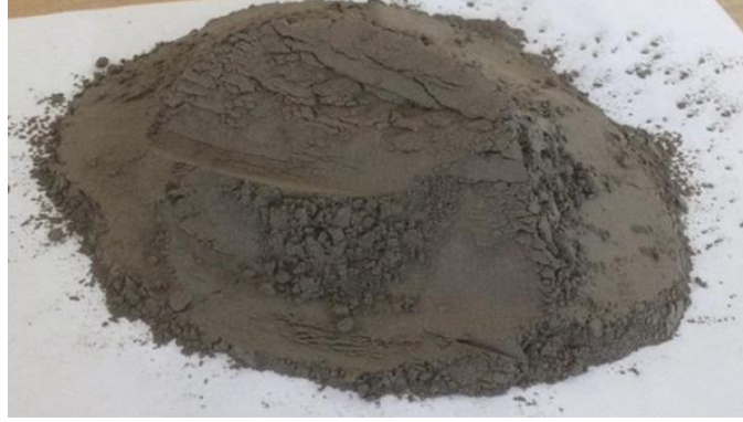
Şekil 2. Çalışmada filler olarak kullanılan Uçucu Kül (Fly Ash used as filler in the study)
