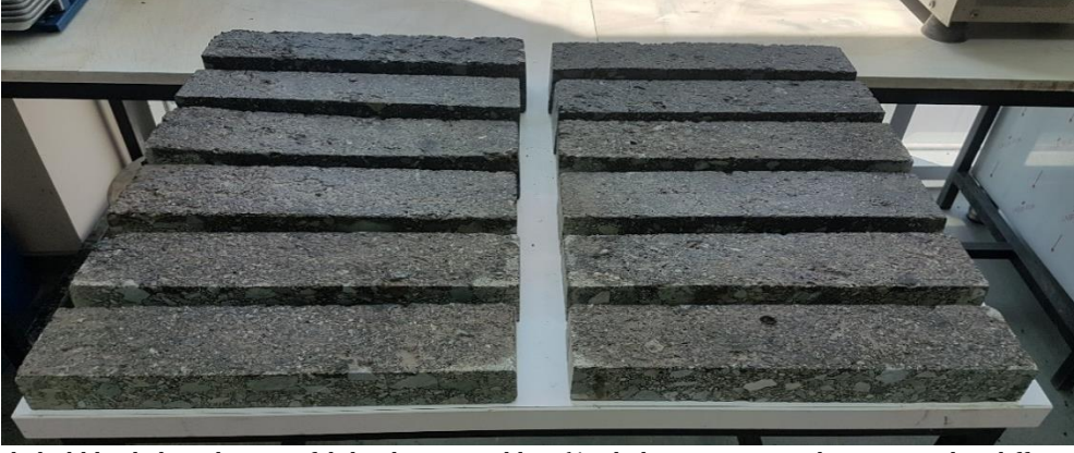
Şekil 1. Farklı kalınlıklarda hazırlanan asfalt kaplama örnekleri (Asphalt mixture samples prepared in different thicknesses)
