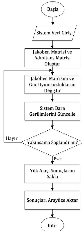
Şekil 1. Güç Akış Eğitim Platformu Algoritma Akış Diyagramı (Power Flow Education Platform Algorithm Flowchart)
