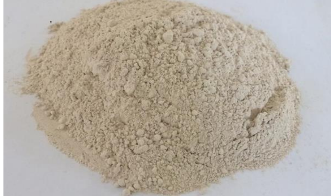
Şekil 1. Çalışmada filler olarak kullanılan kırmataş tozu (Crushed stone powder used as filler in the study)
