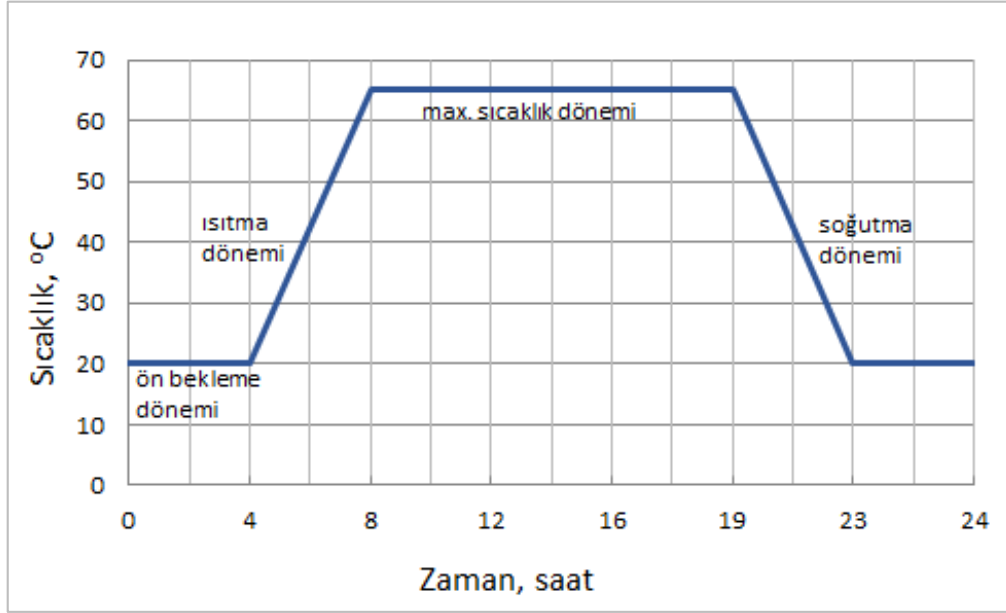
Şekil 2. Buhar Kürü Çevrimi (Steam Curing Cycle)
