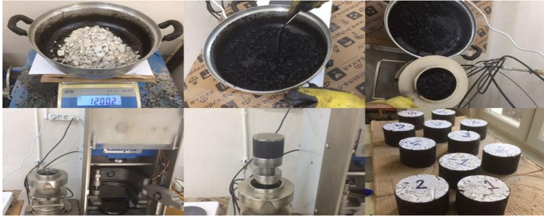
Şekil 3. Superpave Yoğurmalı Sıkıştırıcı ile numunelerin hazırlanması (Preparation of samples with Superpave kneading compactor)
