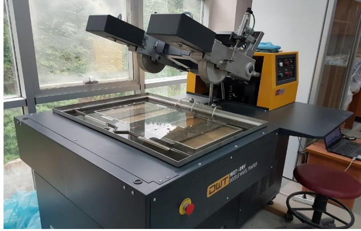
Şekil 2. Hamburg tekerlek izi deney düzeneği (Hamburg wheel tracking test device)
