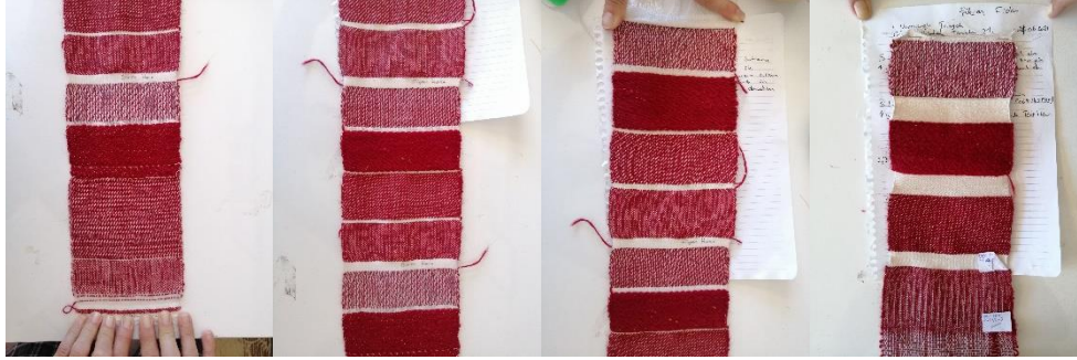
Görsel 13: 1 Nolu Tezgahta Taraktan 2 li Geçirilerek Dokunan Ana Örgülü Dokumalar, Fotoğraf: Mine Beşen Yalçın, 25.06.2021
