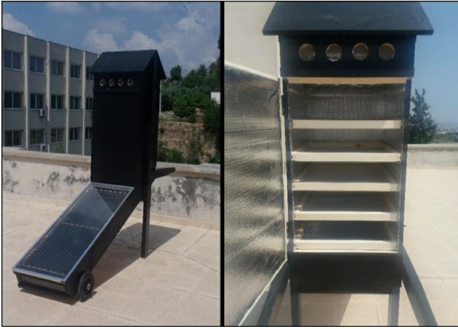
Şekil 1. Çok raflı doğal konvektif güneş enerjili kurutucu
