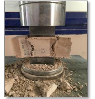
Şekil 7. Numunelere basınç yükü uygulanması
