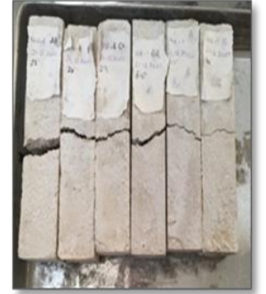
Şekil 7. Numunelere basınç yükü uygulanması
