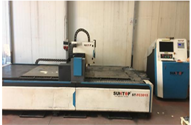
Şekil 2. Deneylerde kullanılan SUNTOP ST-FC3015 marka üç eksenli CNC lazer kesim tezgâhı
