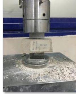
Şekil 7. Numunelere basınç yükü uygulanması
