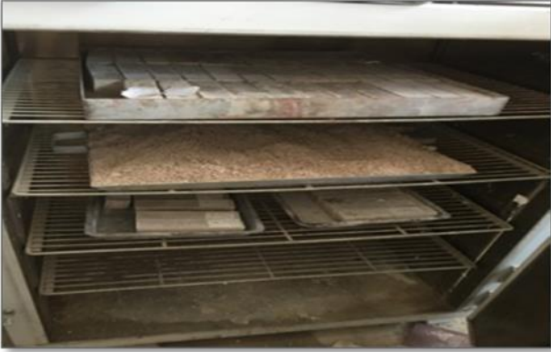
Şekil 5. Harç numunelere sıcaklık kürü uygulanması
