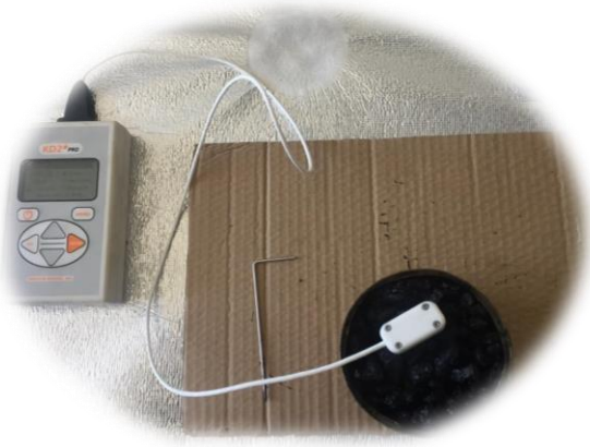
Şekil 3. Asfalt karışım örneklerinin termal iletkenliğinin ölçülmesi
