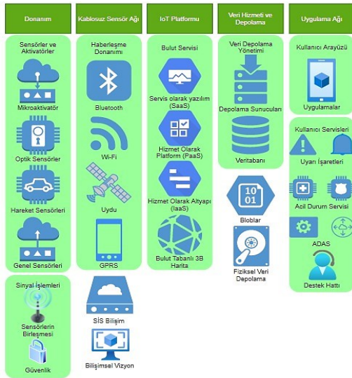
Şekil 3. Akıllı araç genel IoT yapısı
