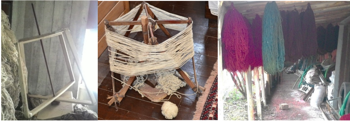
Resim 16. Boyama öncesi çile iplik sarma döndergeç, kök boyalı yün dokuma iplikler(Yamancañ dokuma atölyesi Aral Arşivi).
