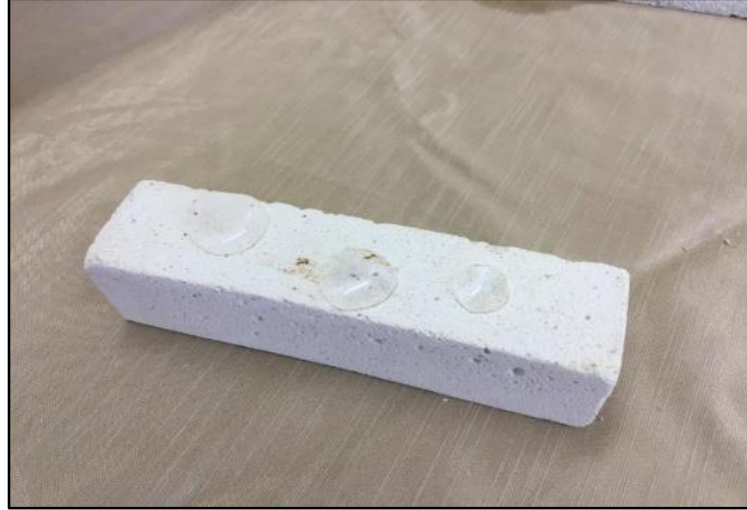
Şekil 5. Polimer bileşenli sertleşmiş harç örneğinin hidrofob yapısına ait bir görünüm
