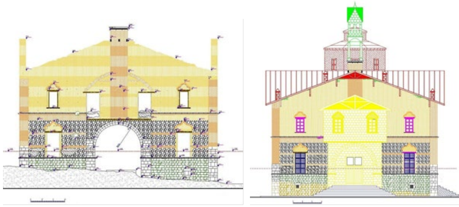
Şekil 25. 26. Elazığ Ermeni Protestan Kilisesi Batı Cephesi Rölövesi ve Restitüsyonu (Ş. Öztürk)
