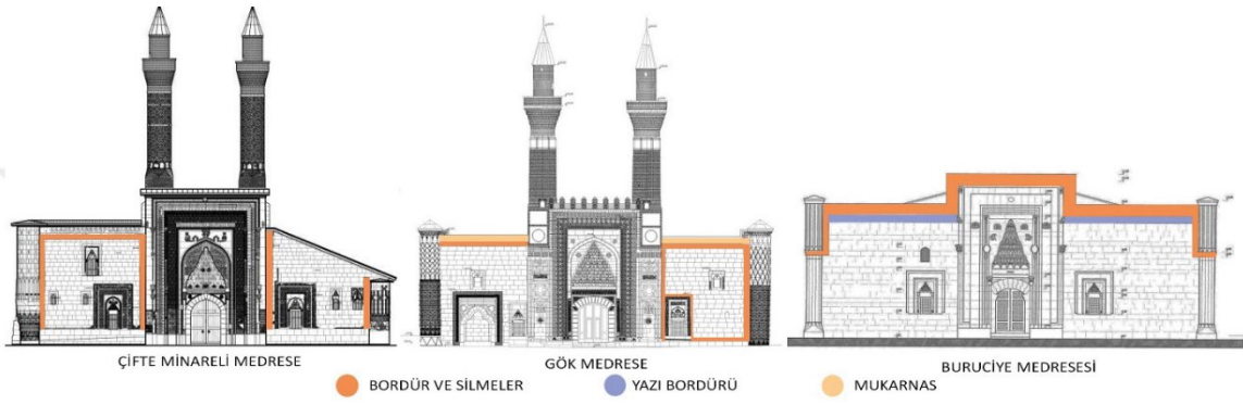
Görsel 18. Giriş Cephelerinde Görülen Bordür ve Silmeler.
