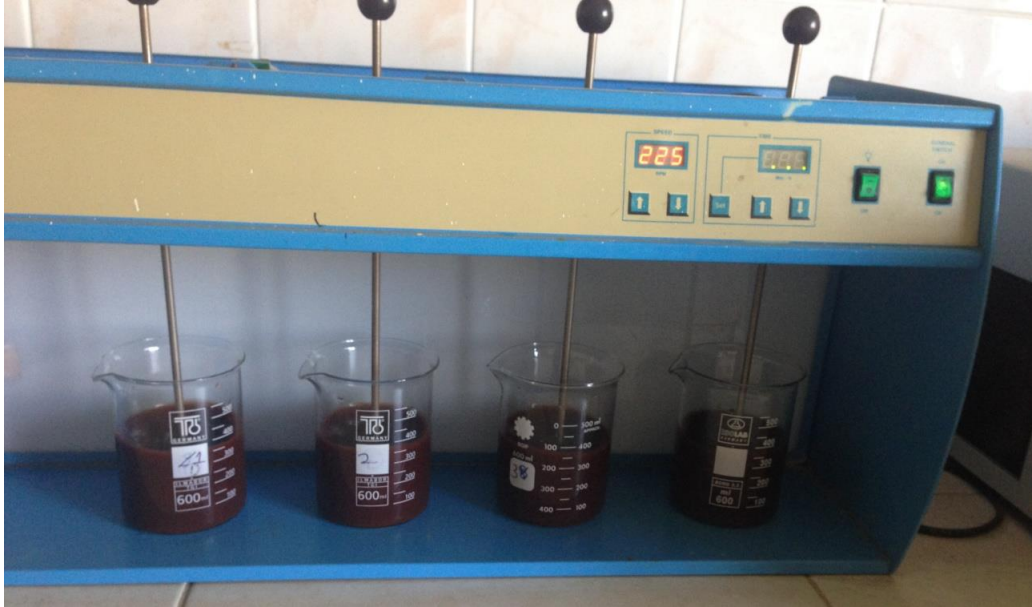
Şekil 1. Jar testi deney düzeneği
