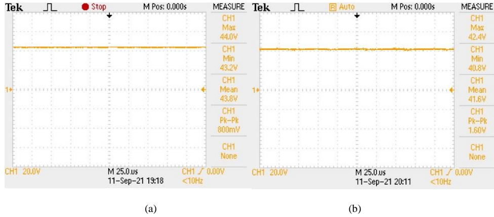
Şekil 17. (a) Dönüştürücü çıkış sinyali. (b) Şarj sırasında alınan dönüştürücü sinyali
