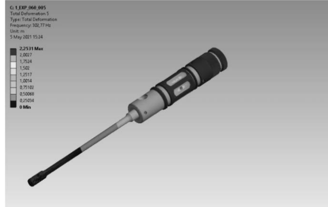
Şekil 14. 1 numaralı numunenin burulma doğal frekansı mod şekli
