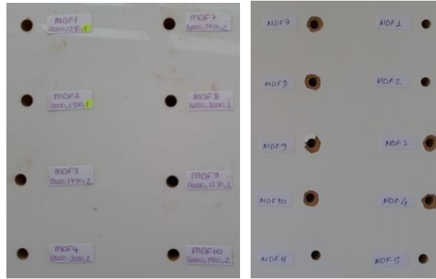
Şekil 3. CNC ile delik delmede delik girişleri (a), delik çıkışları (b)
