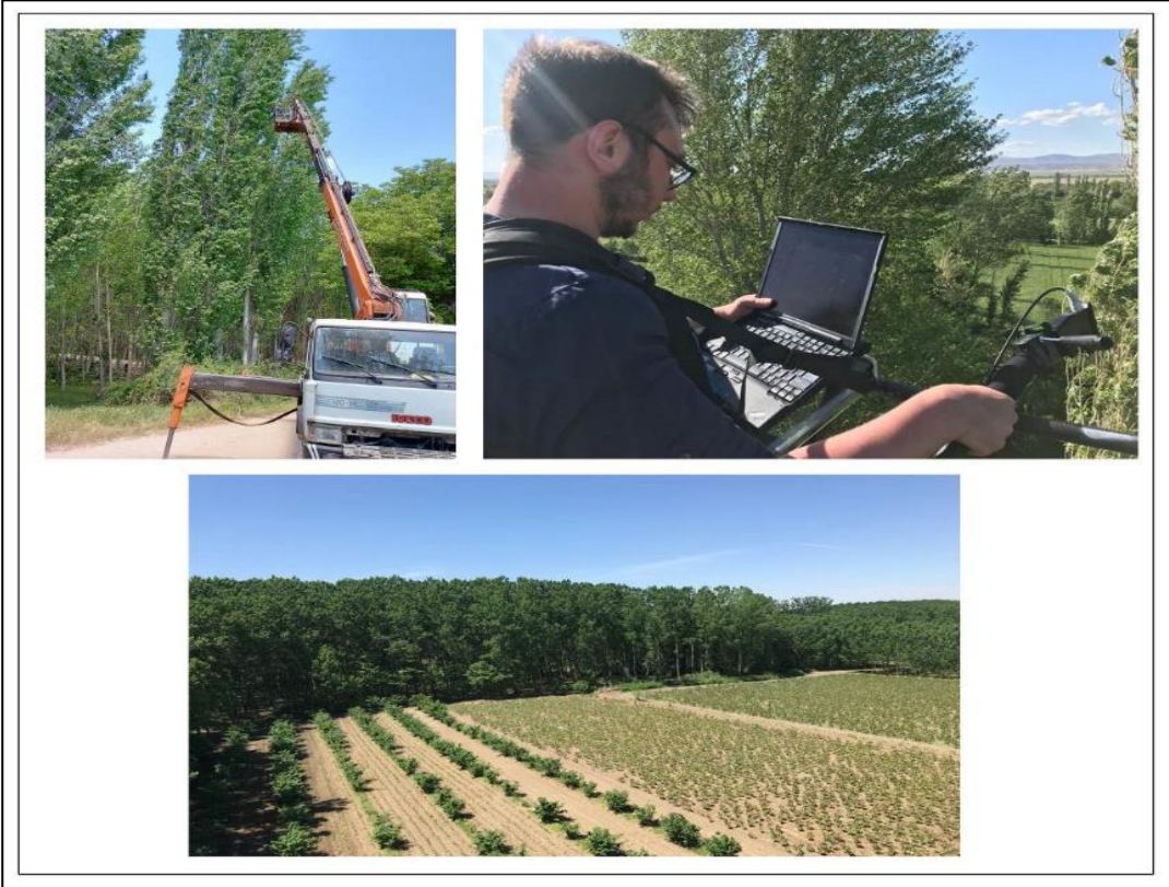
Şekil 6. Çalışma sahalarında gerçekleştirilen kanopi spektral ölçümleri
