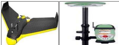
Şekil 10. İHA - eBee SenseFly/ GNSS alıcısı - Leica Viva G08 Plus
