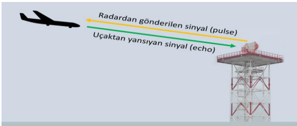
Şekil 2. Birincil gözetim radarı (Primary Surveillance Radar - PSR)
