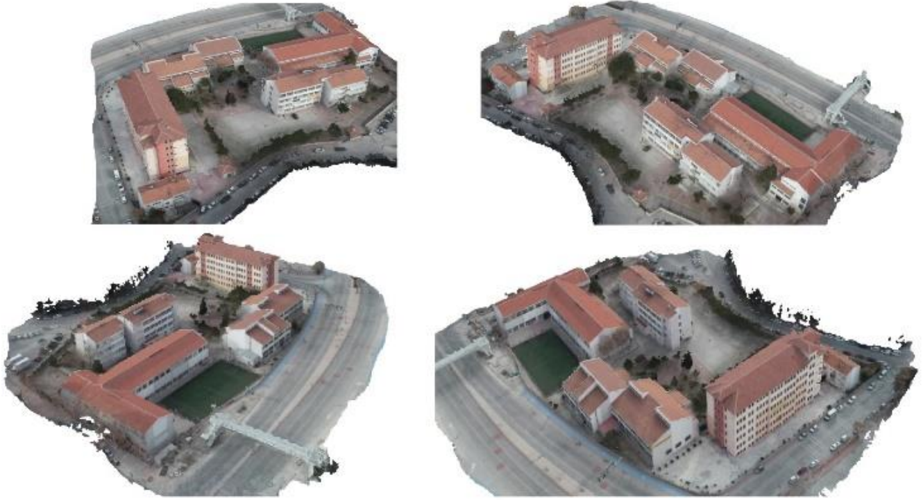
Şekil 6. İHA video verisinden elde edilmiş 3B model
