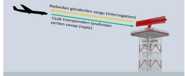
Şekil 3. İkincil gözetim radarı (Secondary Surveillance Radar - SSR)
