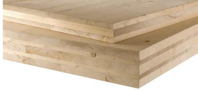
Şekil 3. Çapraz yapıştırılmış lamine ahşap (URL 3)
