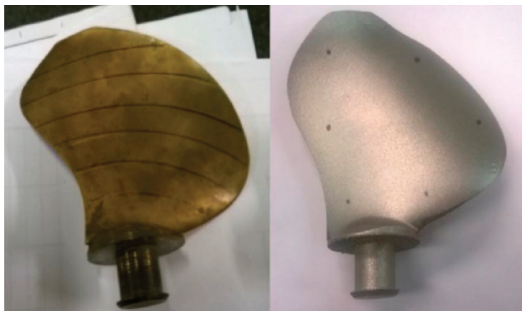
Şekil 7. Kavitasyon deneyinde kullanılan bronz kanat (sol) ve paslanmaz çelikten basılmış kanat (sağ) (Cilia vd., 2019)
