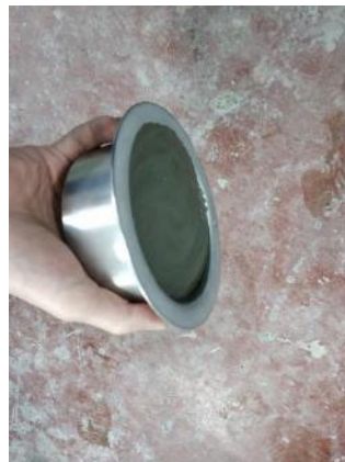
Şekil 2. 0,30 su/çimento ve %0,10 PCE ile hazırlanan C9 çimentosuna ait aşırı katı hamur karışımının reometre kabındaki durumu e-ISSN: 2148-2683
