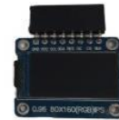
Fig. 6. 0.96'' 80 \times 160 IPS TFT Display Module
