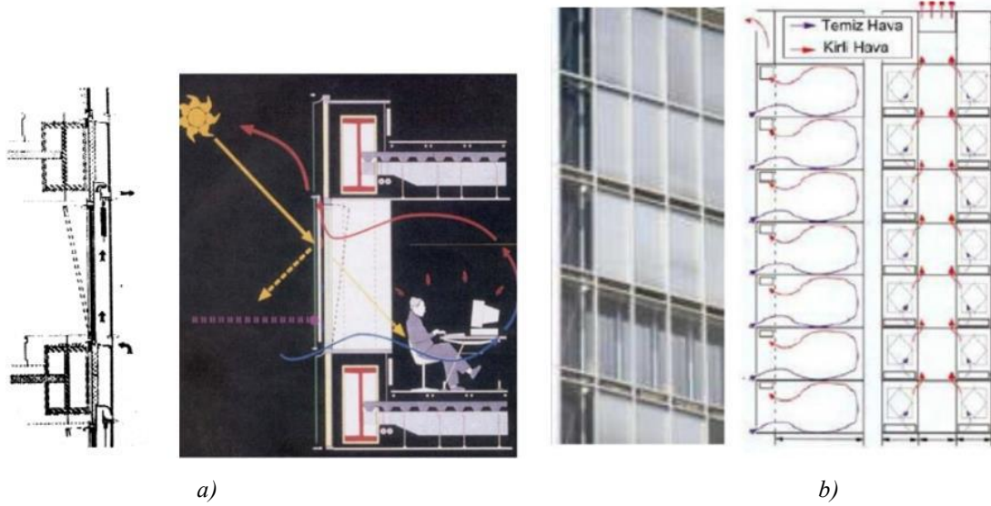
Şekil 1. a) Commerzbank binası dış cephe pasif havalandırma b) Arag 2000 Kulesi 'nin Şaft Tipi Çift Kabuk Cephe Sistemi
