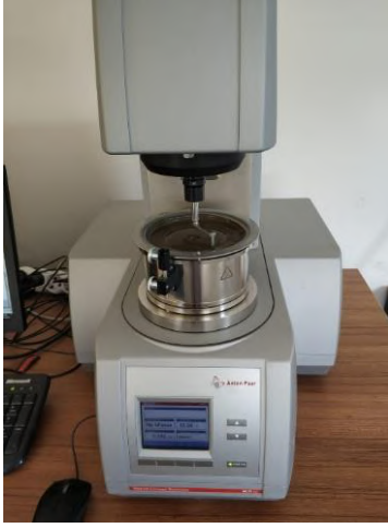
Şekil 1. BMS Ölçüm Sistemine Sahip Reometre
