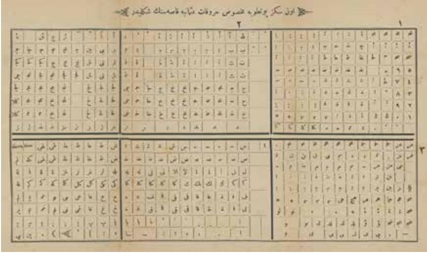
Şekil 2. Şan 'at-ı Tıbb'at yāhūd Mürettiblik, 1893. Ölçüleri 268 × 156 mm'den küçültülmüştür. Mühendisyan tarafından 1883'te üretilen nesih yazı karakterinin 516 parçadan oluşan hurufat kasasının düzeni. 22 (Ömer Durmaz ve Emin Nedret İřli arřivi).
