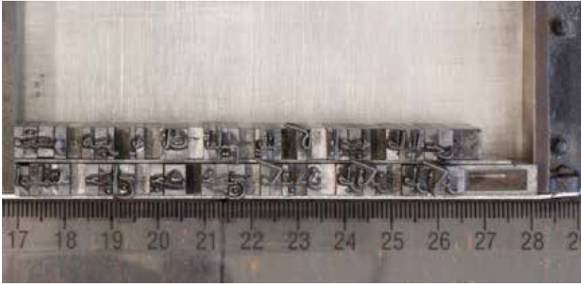
Şekil 4. Hurufat dökümü gerçekleştirildikten sonra kurşun neviler yan yana dizilerek elde edilen metin satırları. (Fotoğraf: Emanuela Conidi Arşivi, University of Reading, İngiltere, 2016)
