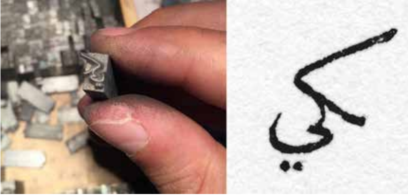
Şekil 3. Solda: Tel Aviv, İsrail’de bir sahafta bulunmuş eksik bir hurufat kasasının 24 punto kurşun alaşımla dökülmüş nesih hurufat nevisi. Tek bir nevi üstünde ortadaki kef (ك) ve sondaki ye (ي) harflerinin bitişmiş şeklinin kabartma halindeki üst yüzey görüntüsü. Sağda: Bu nevisin baskı sonrasında elde ettiği yazı karakterinin sureti. (Fotoğraf ve Baskı: Yazarın kişisel arşivi, İstanbul, 2017)
