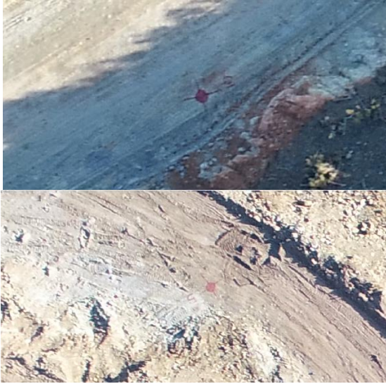
Şekil 2. YKN işaretlerinin arazideki görünümü.
