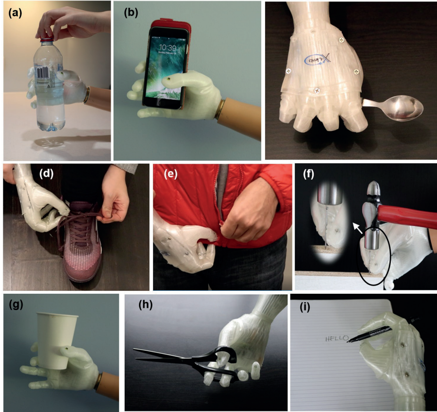
Şekil 5. Çok Eklemlili Yeteneklere Sahip Pratik Bir 3D Baskılı Yumuşak Robotik Protez El
