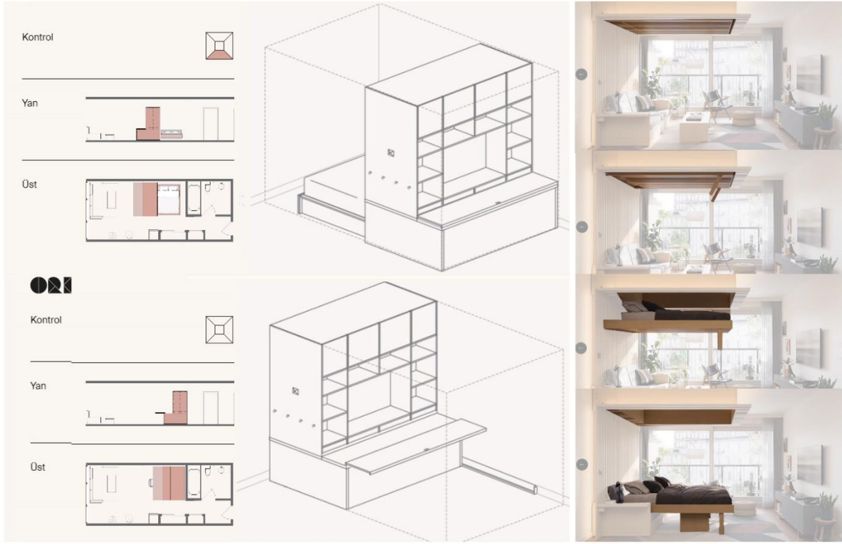
Şekil 9. Ori Suit Studio ve Ori Cloud Bed'in çalışma mantığı. Görseller [28]'den derlenmiş, metnin yazarı tarafından düzenlenmiştir.
