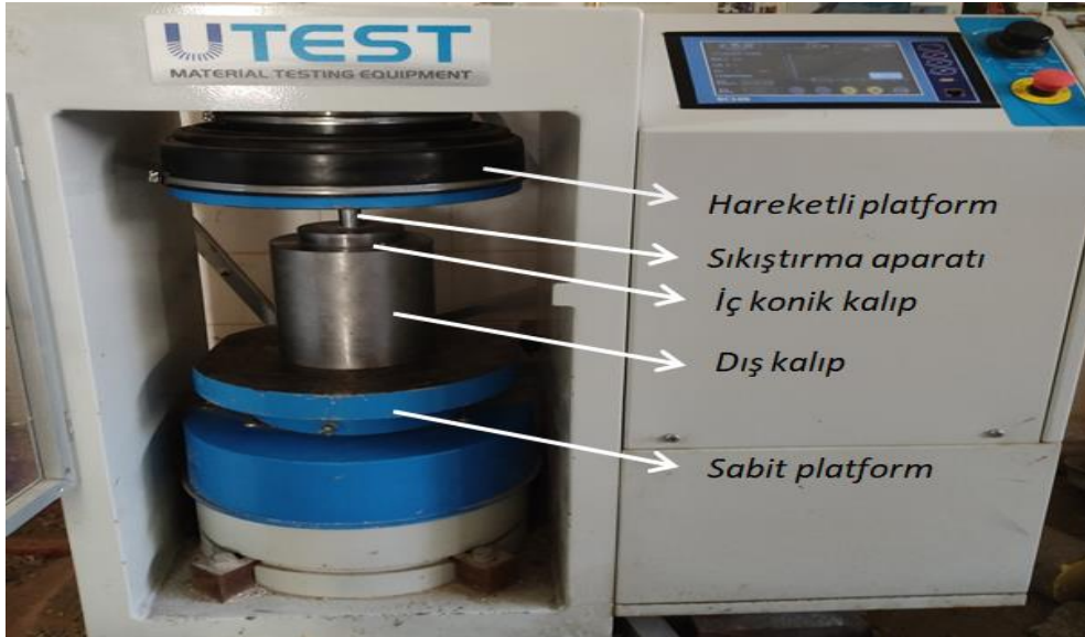
Şekil 2. Al-15Cu alaşım tozlarının sıkıştırılma işlemi
