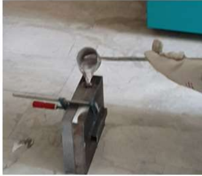
Şekil 2. Sıcak yarıtlma kalıbına döküm işleminin gerçekleştirilmesi.
