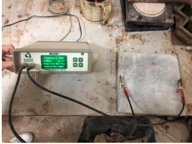
Şekil 2. RCON Elektriksel Direnç Ölçüm Aletinden Ölçüm Sırasında Bir Görünüş
