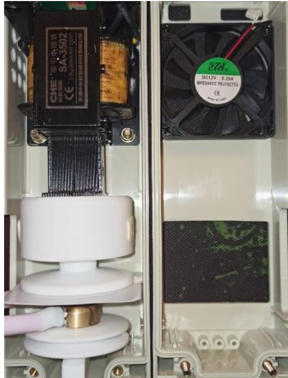
Şekil 3. Solenoid Çekme Bobini ve Darbe Şalteri
