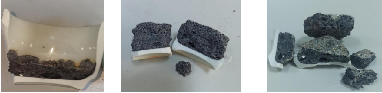
Şekil 1. 1150 °C pişirimi yapılmış numnelere ait görüntüler (a): SMLK 1, (b): SMLK 2, (c): SMLK 3.
