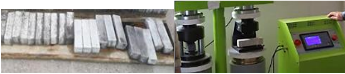
Şekil 1. Boraks Pentahidrat ikameli çimento harçları ve mekanik deneyler
