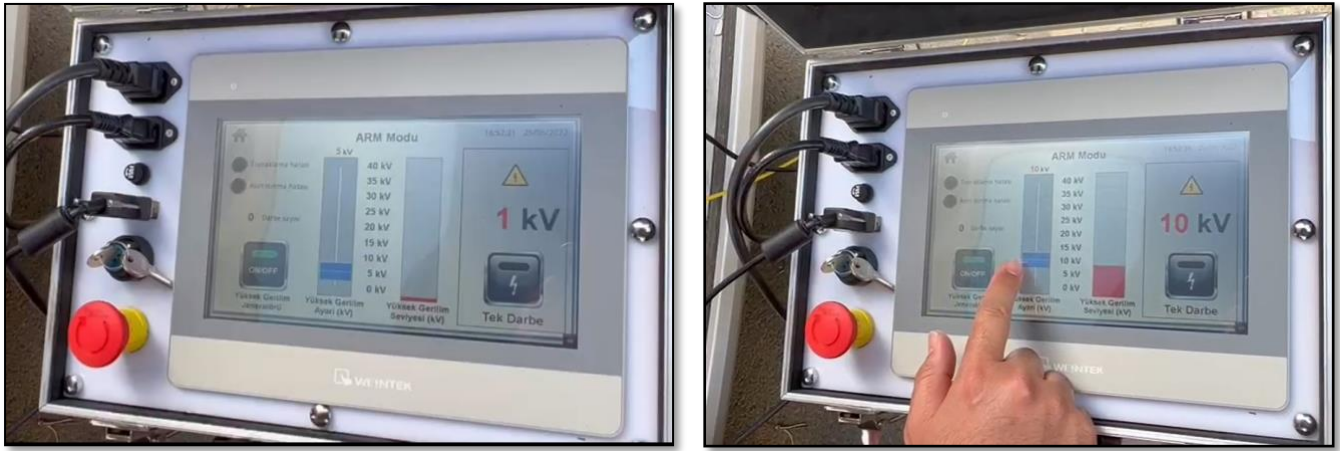
Şekil 6. DC çalışma modu 1kV ve 10kV referans değerleri için elde edilen ekran görüntüleri
