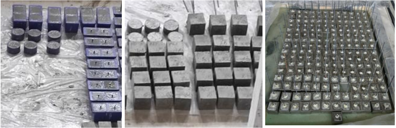
Şekil 4. Donatılı ve donatısız beton numunelerin üretimi ve küri
