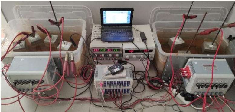
Şekil 6. Hızlandırılmış korozyon deney düzeneği
