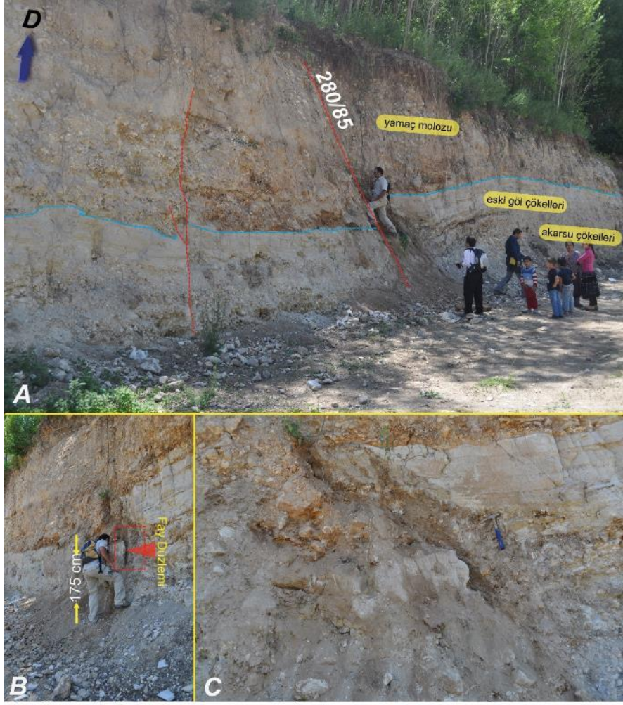
Şekil 8. A. Çubuklu Segmenti'nin arazideki görünümü, B. fay düzlemi ve meydana gelen düşey ötelenme C. fay düzleminin yakından görünümü.
