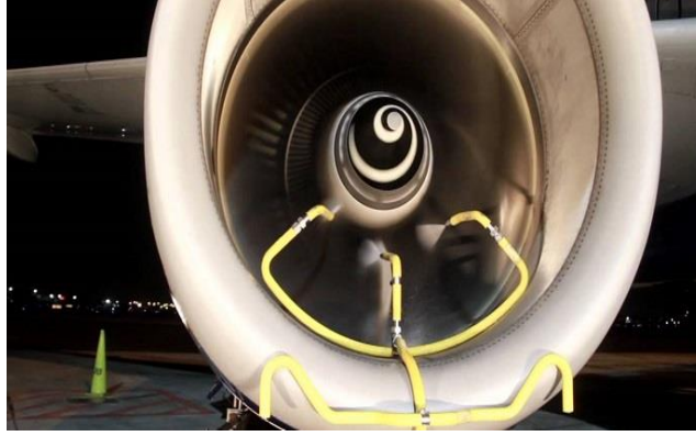
Şekil 6. Sıvı Enjeksiyonlu Motor Yıkaması (URL-2)
