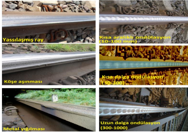
Şekil 3. Ray enine ve boyuna yüzey kusurları [4]
