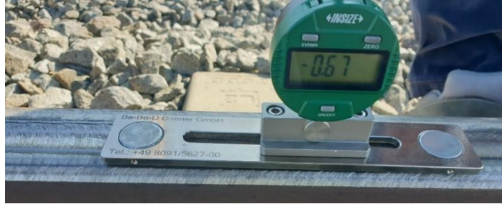
Şekil 10. Düzeltici yeniden profillendirme öncesi kusur derinliği ölçümü
