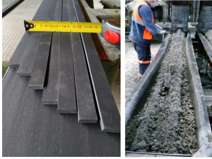
Şekil 4. Yeni geliştirilen 15x4,9 mm ebatlı L-CFRPU donatılı yeşil traversin üretimi
