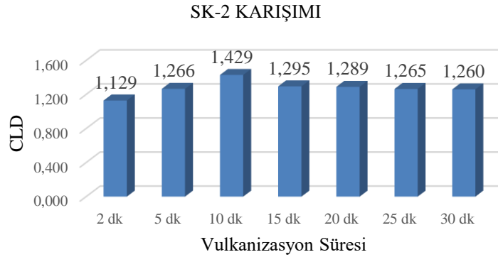
Şekil 2. SK-2 Karışımına Ait Farklı Vulkanizasyon Sürelerindeki Çapraz Bağ Yoğunlukları
