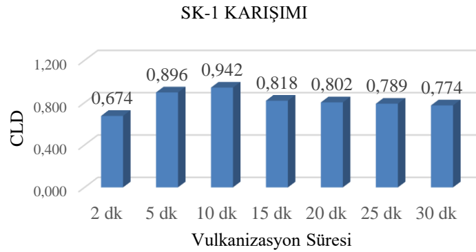
Şekil 1. SK-1 Karışımına Ait Farklı Vulkanizasyon Sürelerindeki Çapraz Bağ Yoğunlukları
