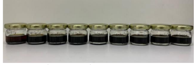
Şekil 3. Dizel/pirolitik yağ/n-bütanol karışımları.
