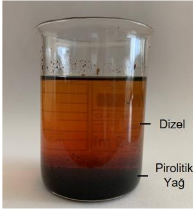
Şekil 2. Faz ayrımı (ağırlıkça %90 dizel %10 Pirolitik yağ).
