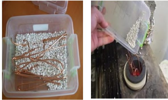
Fotođraf 9. Alaşımın ayarlanıp potada eritilmesi işlemleri (Nil Döküm, 2009).
