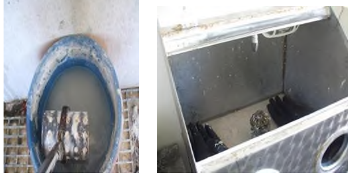
Fotoğraf 13. Döküm işlemi sonrası alçı temizleme işlemi; sıcakken soğuk suya batırılır. Fanusun kalan alçılardan tamamen temizlenmesi için alçı temizleme makinesinde basınçlı su uygulanması işlemi (Nil Döküm, 2009).
