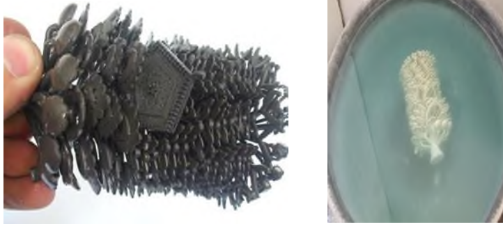
Fotoğraf 14. Alçıdan temizlenmiş modeller ve nitrik asitli suya atılarak ağartılması işlemi (Nil Döküm, 2009).
