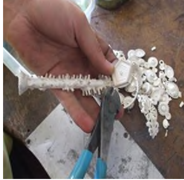
Fotoğraf 15. Modellerin tesviye yapılmak üzere ağaçtan makas yardımıyla ayrılması işlemi (Nil Döküm, 2009).
