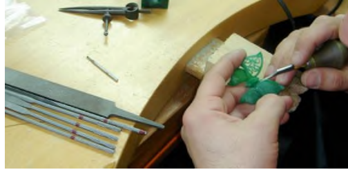
Resim 1. Kuyumculuk aletleri ile mum modelin şekillendirilmesi işlemi (25 Ayar.com, 2018).
