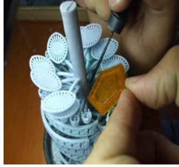
Fotoğraf 3. Reçine modelin lehim aleti yardımı ile mum ağaca eklenmesi (Nil Döküm, 2009).
