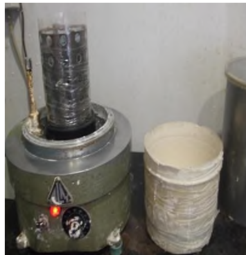
Fotoğraf 5. Fanusun alçılama öncesi vakum makinesinde havasının alınma işlemi (Nil Döküm, 2009).
