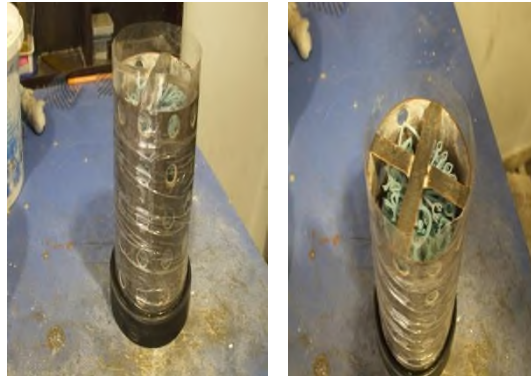
Fotoğraf 4. Mum modellerin olduğu ağacın alçıya alma işlemi öncesi fanusa yerleştirilmesi işlemi (Nil Döküm, 2009).
