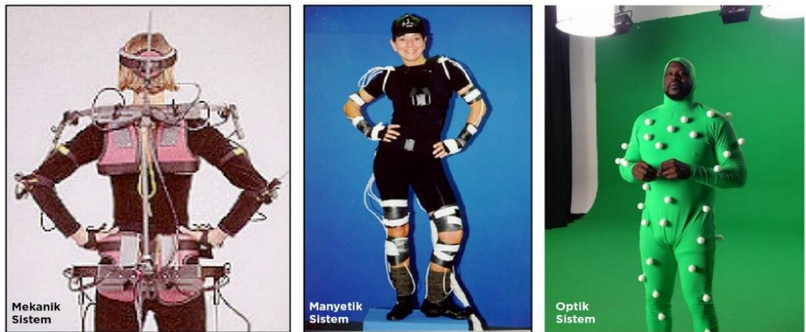
Şekil 2. Mekanik, manyetik ve optik hareket yakalama sistemleri.
