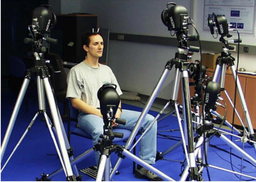
Şekil 3. İşaretleyici tabanlı olmayan hareket yakalama sistemi.
