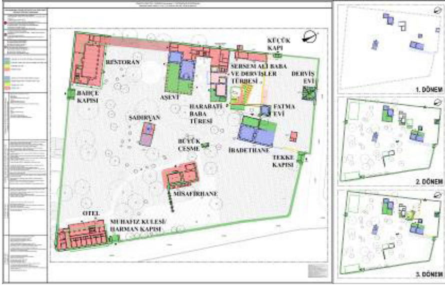
Şekil 3: Harabati Baba Tekkesi Restitüsyon Dönemlemesi. Mavi ile Belirtilen Yapılar 1. Dönemi, Yeşil Olanlar 2. Dönemi, Sarı 3. Dönemi ve Pembe 4. Dönemde Yerleşkeye Dahil Olan Yapıları ve Ekleri Temsil Etmektedir. (Kaynak: Ekol Mimarlık Arşivi)
