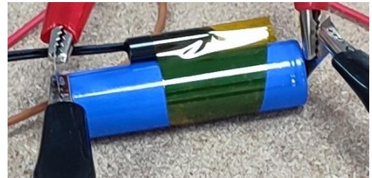
Şekil 8. Termistörün Li-Ion pil yüzeyine bağlantı şekli (Figure 8. Connection of thermistor to Li-Ion battery surface)
