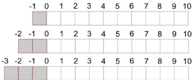
Figure 4. In T=10 TS time horizon, white-color TSs show online scenarios while dark-colored ones show the histories. (Şekil 4. T=10 TS zaman ufkunda açık renkli zaman dilimleri çevrimiçi senaryoları gösterirken koyu renkli olanlar geçmişleri gösterir.)
