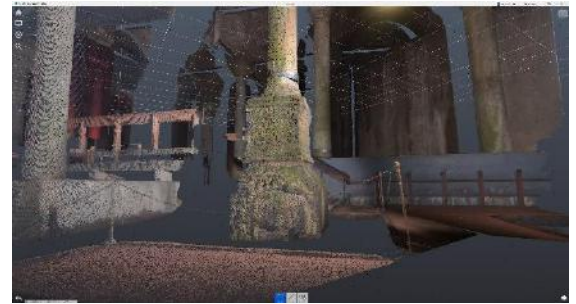
Şekil 6. Proses işlemi sonucu elde edilen nokta bulutu verisinin Autodesk Recap programında görünümü (Figure 6. The view of the point cloud data obtained as a result of the process in the Autodesk Recap program (İBB/Bimtaş Arşivi)
