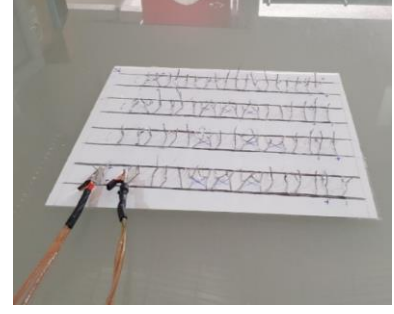
Şekil 7. Test için flash test cihazına panel bağlantısının yapılması
