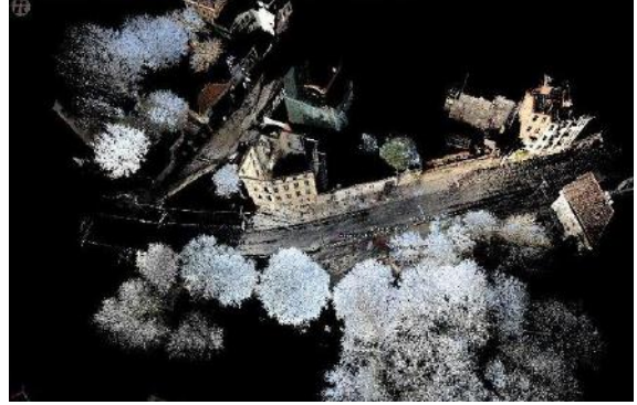
Şekil 4. Yersel lazer tarama sonucu elde edilen dış mekân nokta bulutu verisi (Figure 4. Exterior point cloud data result from tellurian laser scan) (İBB/Bimtaş Arşivi)
