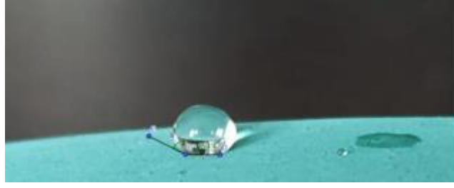
Şekil 6. Floropolimer Esaslı Malzeme İle Kaplanmış Kanat Profilinde Su Damlasının Yüzeyle Temas Açısının Belirlenmesi ( \Theta=154^\circ > 150^\circ : Süperhidrofobik).
