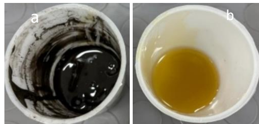
Resim 2. Üretimde kullanılan reçineler; a) Nano bor katkıli epoksi reçine b) Katkısız epoksi reçine
