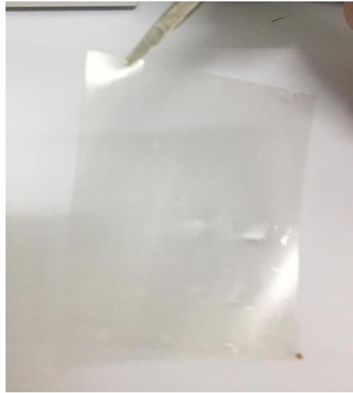
Şekil 7. Tek Katmanlı Grafen SEM Numunesi
