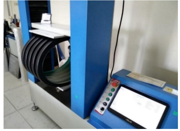
Şekil 9. Koruge borunun halka rijitliğinin test edilmesi.
